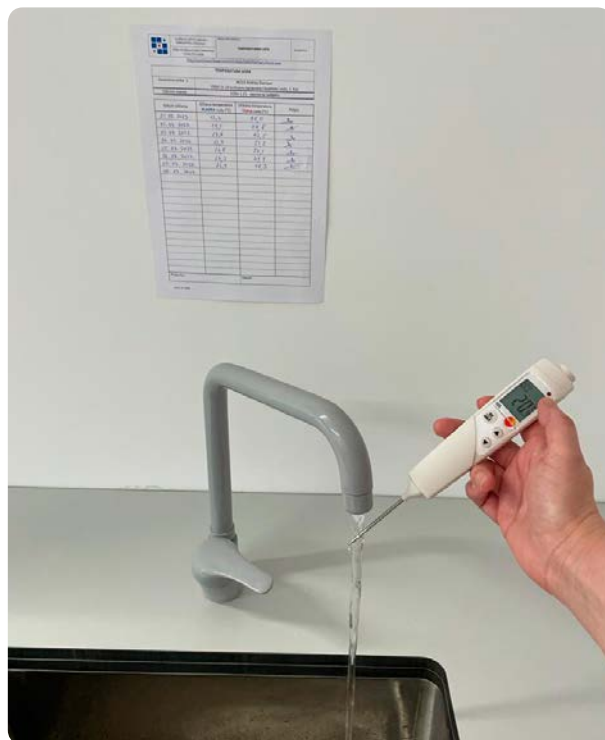
Slika 1. Ubodni termometar i temperaturna lista za samokontrolu temperature (Izvor: NZJZ „Dr. A. Štampar“)
